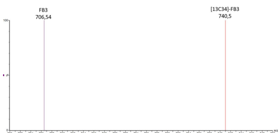
Spectre MS de la Fumonisine B3 et étalon LIB'UP® U-[ 13 C34]-Fumonisine B3
