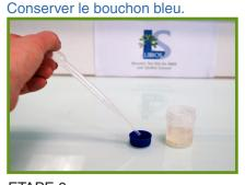
ETAPE 6 : À l'aide d'une pipette, transférer le surnageant dans le bouchon bleu (le bouchon doit être plein).
