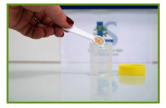
ETAPE 2 : Ajouter un gramme\* de l'échantillon dans un tube à bouchon jaune.
