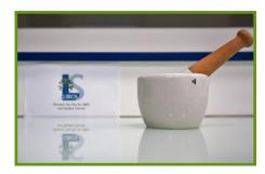
ETAPE 1: Broyer à l'aide d'un mortier ou d'un blender l'échantillon afin d'obtenir une poudre aussi fine que possible.
