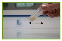
ETAPE 4: Agiter pendant 15-30 secondes à l'aide d'un vortex ou d'un agitateur mécanique (ou 1-2 minutes à la main).
